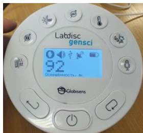
Рис. 1. Экран при замере датчика «Освещенность»
