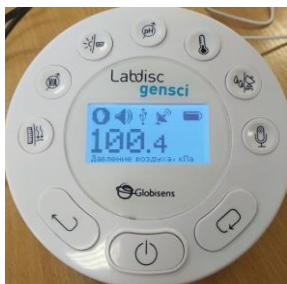
Рис. 2. Экран при замере датчика «Давление воздуха»
