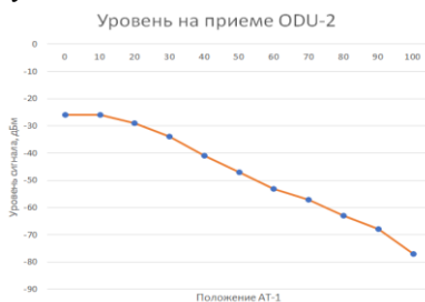
Рис. 1. Исследование влияния вносимого затухания на уровень принимаемого сигнала: (а) – при передаче сигнала от ODU-2 к ODU-1; (б) – ODU-1 и ODU-2
